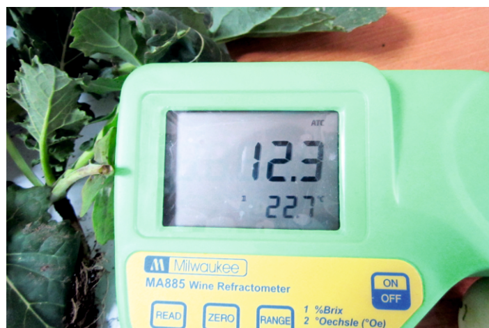
Определение содержания сухих веществ в клеточном соке растений перед проведением подготовки растений к перезимовке с помощью обработки 1,0 % раствором ПРК «Белый Жемчуг Антифриз» в ООО «Кампоферма» Московской области
